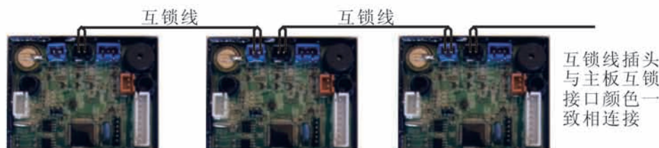
图3-9 互锁的接线图
