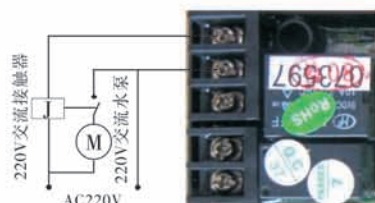
图3-8进口接增压泵的接线图
